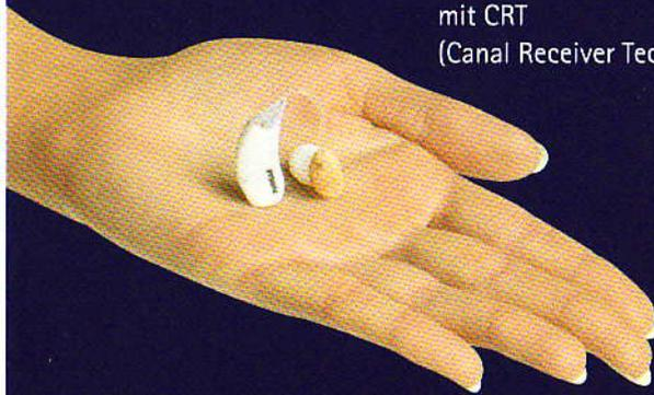
Das innovative Design von microPower basiert auf der Ex-Hörer-Technologie CRT (Canal Receiver Technology). Dabei befindet sich das Mikrofon im kleinen Gehäuse hinter dem Ohr, während der Lautsprecher unmittelbar im Gehörgang sitzt.
